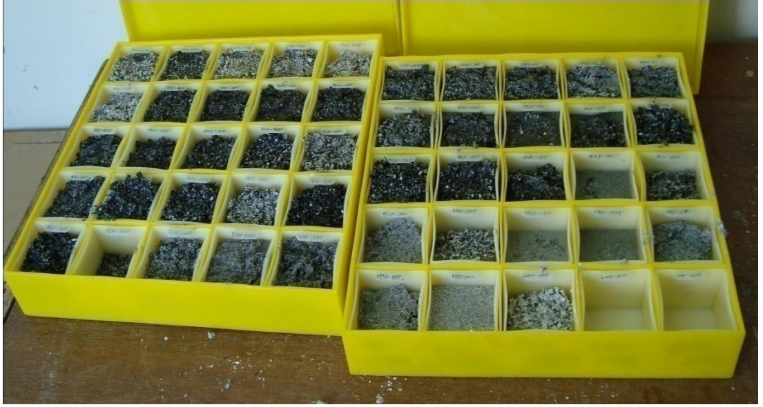
Foto 4.3. Kuyudan gelen kırıntıları saklama kutuları
