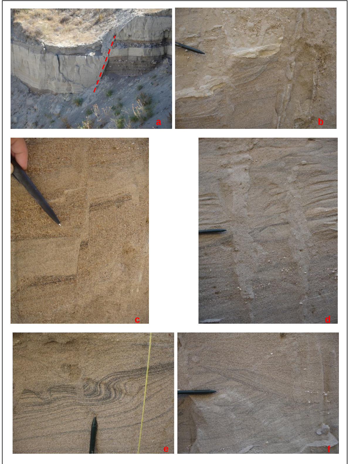
Şekil 37. Burdur Fethiye fay zone üzerinde açılan BUR-2 hendekinin farklı lokasyonlarının görünüşleri. a: 1914 depremini oluşturan fayın atımı ( \approx 4\text{m} ); b: kaotik zon; c: plaj tortullarında görülen mikro fay; d: 1914 depremi esnasında meydana gelen sıvılaşmalar; e: plaj tortullarında faylanmaya bağlı oluşan mikro kıvrımlar; f: plaj tortullarında gözlenen çapraz katmanlanmalar.
