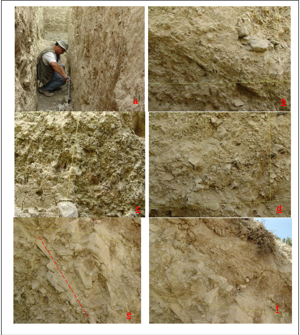
Şekil 35. Burdur Fethiye fay zonu üzerinde açılan BUR-1 hendeğinin farklı seviyelerinin görünümleri. a: BUR-1 hendeğinin genel görünümü; b: Yeşilimsi kahverengi organik malzeme içeren kil; c: Pekleşmiş yeşilimsi kil ve az miktarda köşeli çakıllar; d: Pekleşmiş kil çamuru içerisinde kötü boyanmalı çakıllar; e: İri çakıllı seviye ve fay izi; f: Güncel yamaç çökelleri ve güncel ova çökelleri.
